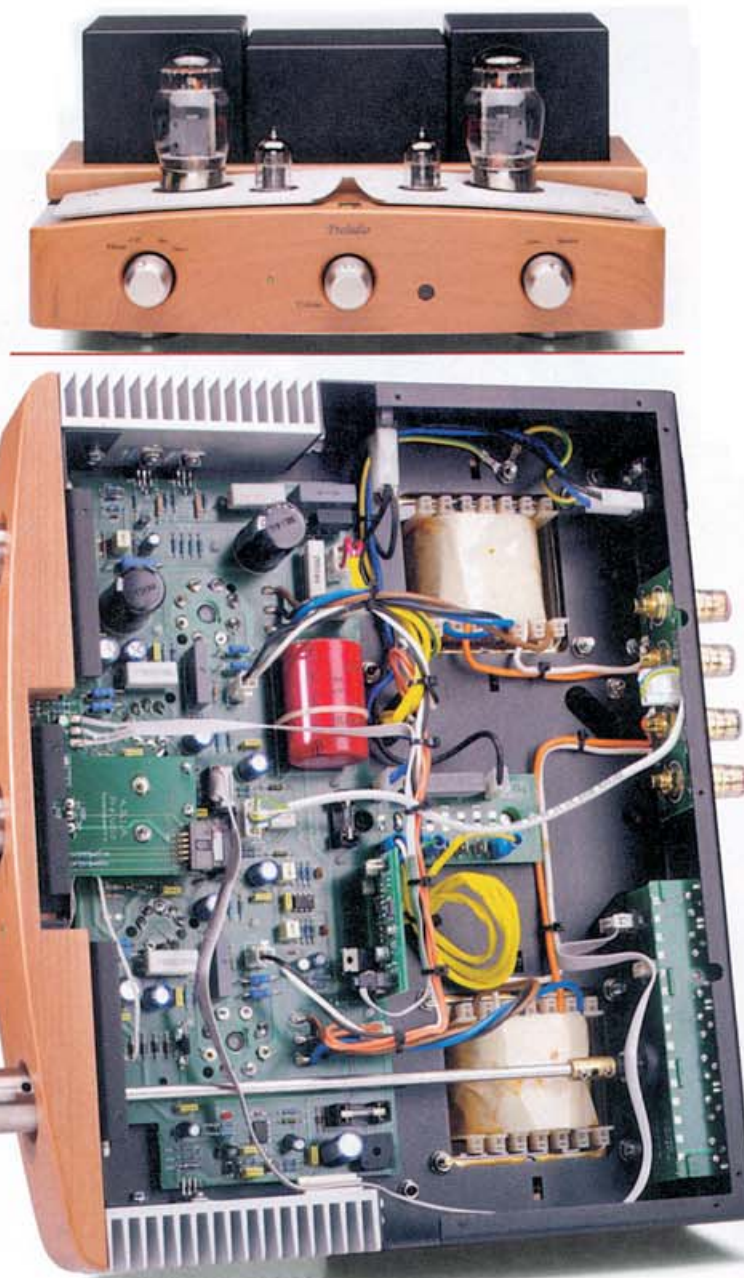
Italianische Feinkost: Die Transistoren am oberen Alu-Kühlkörper helfen, die Endstufen-Hochspannung zu säubern, das IC am unteren Profil hält die Vorstufen-Heiz- und Endröhren-Kathodenspannung konstant.
