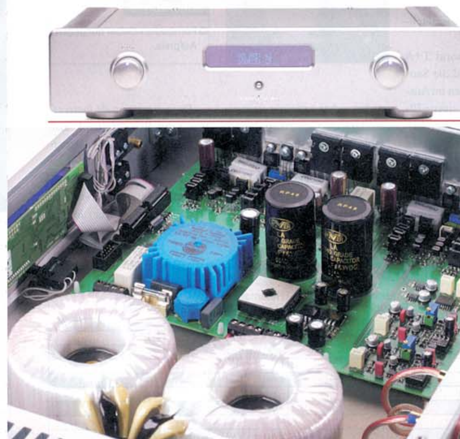
Rosbacher Ordnungssinn: Der Platinen-Trafo ernährt die digitale Bedienelektronik, die vorgeschaltete kleine blaue Drossel unterbindet Rück-Einstreuungen in das Netz und auf die großen Umspanner. Auf der rechten Seite die Phono-Sektion.
