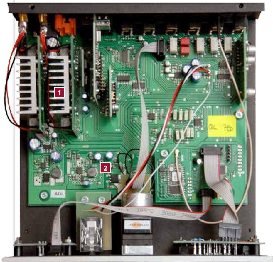
1 DOS PEQUEÑOS PERO ROBUSTOS DISIPADORES TÉRMICOS SE ENCARGAN, CON LA INESTIMABLE AYUDA DE LA ESTRUCTURA METÁLICA DEL MAIA DS, DE ASEGURAR QUE LA TEMPERATURA DE FUNCIONAMIENTO DEL APARATO SEA MUY COMEDIDA.
