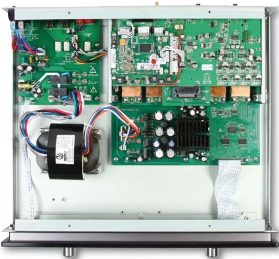
FREUND UND KUPFERBECHER: Gülden glänzende Blechhauben dienen bei den diskreten Verstärkungsmodulen der Pre32 zugleich der Kühlung und Abschirmung. Über den Erweiterungs-Steckplatz in ihrer Mitte nimmt das Media-Board (im oberen rechten Viertel) Kontakt zur Hauptplatine auf.
