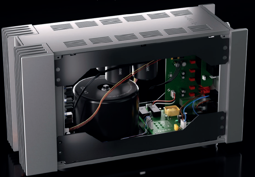
▼ El interior de la etapa de potencia
