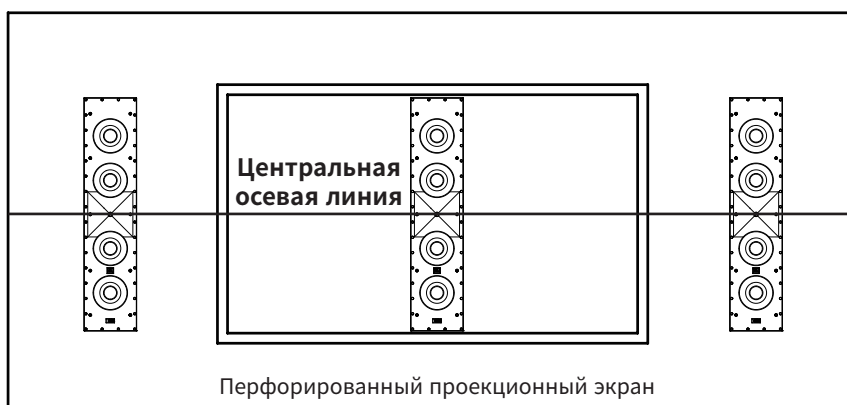
Примечание: Колонку следует устанавливать максимально близко к горизонтальной осевой линии.
