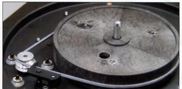
Dickes Blech-Chassis, solider Pulley, präziser Innenteller: Das Laufwerk des Vinyl 2000 kann sich sehen lassen.
