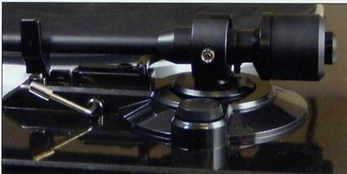
Starke Führung: Mit seinem steifen, spielfrei gelagerten Arm lädt der Denon zu Tonabnehmer-Upgrades ein.
