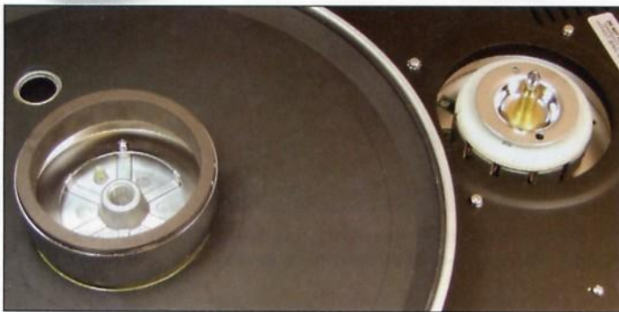
Drehmoment für Erwachsene: Der Magnetring des mächtigen Motors ist direkt am gummiarmierten Aluteller angeflanscht.
