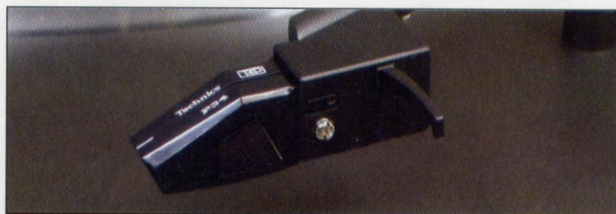
Was man in den 80ern unter Plug and Play verstand: T4P-Abtaster lassen sich in Sekunden wechseln, sind heute aber selten geworden.
