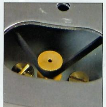
Ungewöhnliche Konstruktion: Die Mittelachse des Tellerlagers (links) steht fest. Ein kleiner Gleichstrom-Motor (rechts) treibt den Spieler an.
