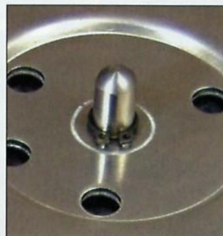
Ungewöhnliche Konstruktion: Die Mittelachse des Tellerlagers (links) steht fest. Ein kleiner Gleichstrom-Motor (rechts) treibt den Spieler an.
