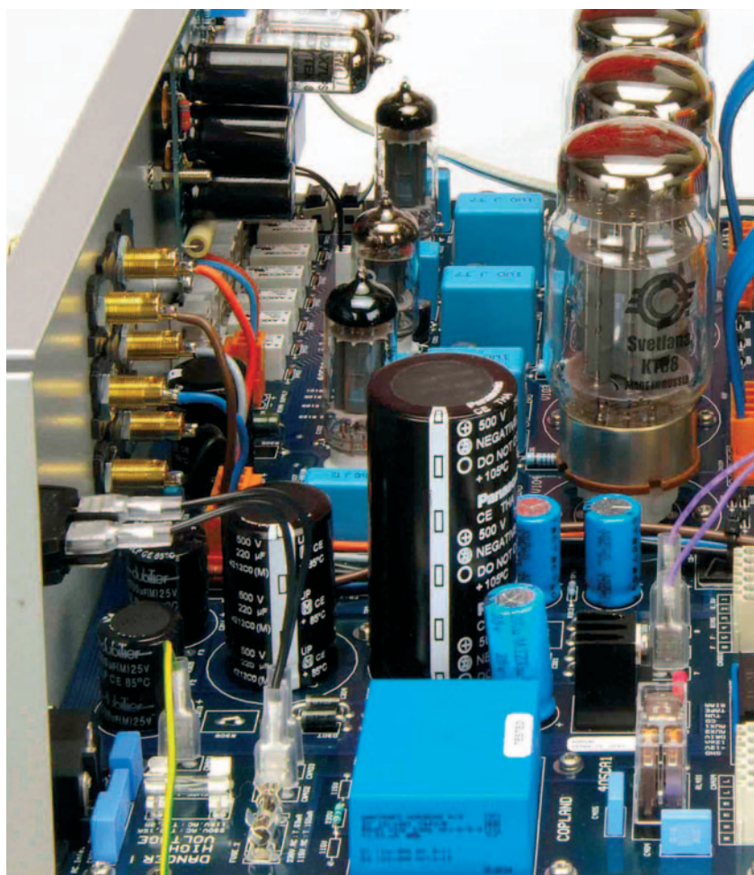
La elevada calidad de las válvulas y el sistema de alimentación y la manera en que aquéllas han sido configuradas son responsables directos la excepcional calidad sonora del CTA. Observen los cuatro dobles triodos que responsables de la sección de fono, literalmente pegados a los correspondientes terminales de conexión.
